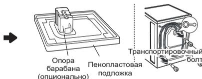
Снимите транспортировочные болты и опоры.
