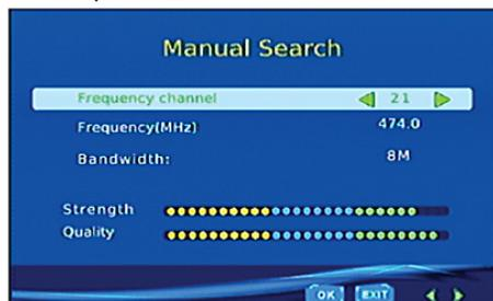
Кнопками **VOL- ◀/VOL+ ▶** установите номер канала, затем нажмите кнопку **OK**, чтобы начать поиск. Найденный канал будет сохранен под установленным номером.
