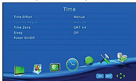
**Time Offset – Сдвиг времени.** Выберите автоматическую установку часового пояса в соответствии с информацией о часовом поясе в принимаемом сигнале (Auto) или установку вручную (Manual).
