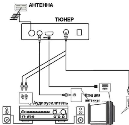
Подключите к проигрывателю телевизор в соответствии со схемой выше. Это необходимо сделать до начала работы с прибором.
