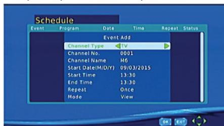
Нажмите кнопку **EPG**, чтобы перейти в электронное расписание. Нажмите **СИНИЮ** кнопку, чтобы перейти в меню планирования видеозаписей. Нажмите **КРАСНУЮ** кнопку, чтобы запланировать видеозапись, отрегулируйте параметры видеозаписи (время начала и окончания видеозаписи и др.), затем нажмите кнопку **OK** для подтверждения. Чтобы закрыть меню, нажмите кнопку **EXIT**.
