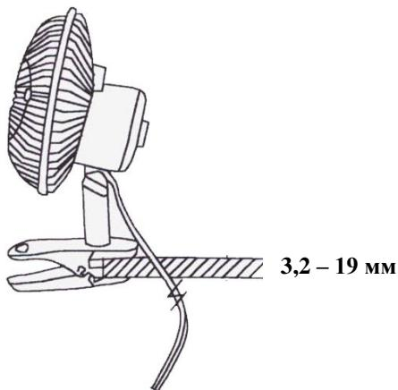
С помощью клипсы (зажима) прибор может быть установлен на плоской поверхности, толщиной 3,2 – 19 мм. Перед тем, как установить вентилятор с помощью клипсы, убедитесь, что поверхность достаточно прочная и устойчивая.
