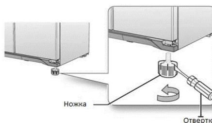
В случае необходимости, следуя не сложным инструкциям, вы можете отрегулировать двери по уровню после установки холодильника. Для этого ослабьте нижнюю регулировочную гайку, повернув её по часовой стрелке с помощью ключа. Затем, вращая по- или против-часовой стрелки верхнюю регулировочную гайку, выровняйте двери друг относительно друга и зафиксируйте положение, затянув нижнюю гайку. Таким способом двери могут регулироваться в пределах 5мм.
